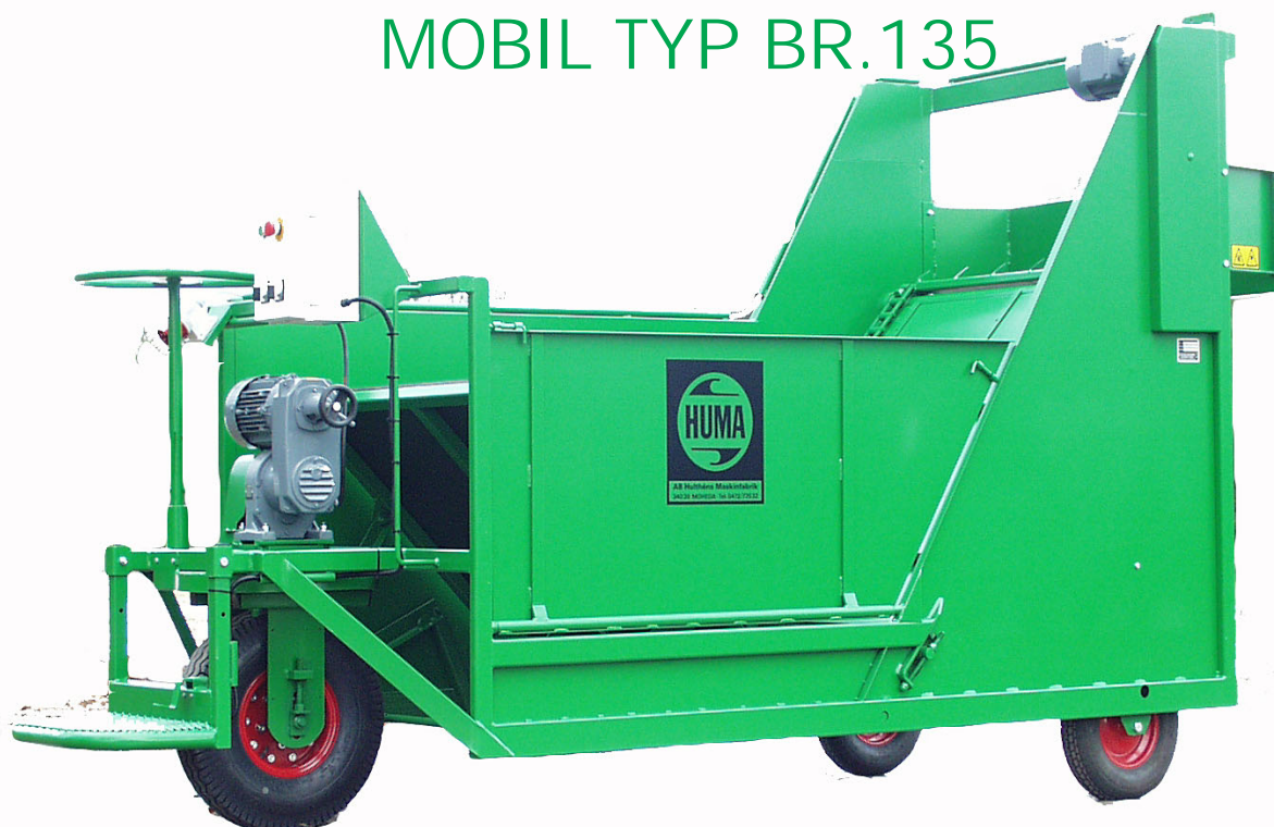
Upprullaren på bilden är utrustad med fällbar läm på höger sida
